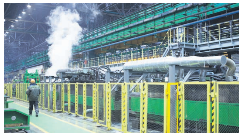
△ Вытяжка выводит испарения за пределы цеха © ВАЛЕРИЙ ПОКУМЕЙКО
